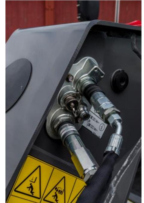
Sistema de acoplamiento rápido en los modelos TL
